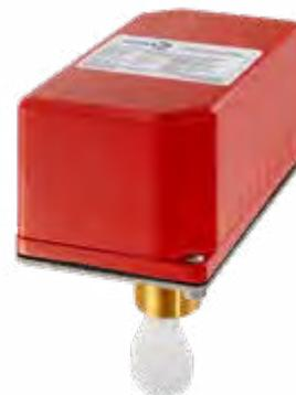
Резьбовой сигнализатор потока жидкости представляет собой реле расхода воды лопастного типа для использования в «мокрых» спринклерных системах с трубами диаметром 1" (25 мм), 1 1/4" (32 мм), 1 1/2" (38 мм) или 2" (50 мм). Устройство также может использоваться в больших системах в качестве секционного датчика расхода воды.
