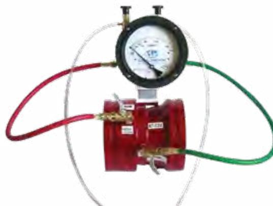
Используется для периодического контроля расхода насосных систем. Расходомер обычно устанавливается между обратным клапаном изадвижкой с наружным винтом и маховичком в напорных линиях насоса. Диаметр расходомера определяется расходом насоса.
