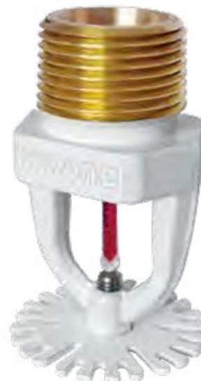
Спринклеры ELO используются в системах, спроектированных в соответствии с соотношениями плотности/площади. По сравнению со стандартными спринклерами они имеют преимущество в работе с более низким давлением при более высоком расходе.
