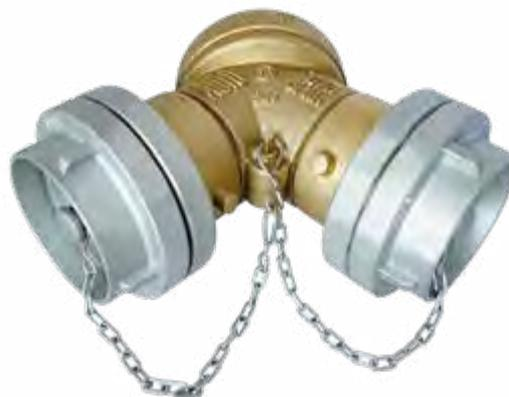
Монтируется снаружи здания, используется пожарной службой для подачи воды в существующие спринклерные и противопожарные шкафы. Используется в сочетании с обратным клапаном. При наличии риска заморозания воды следует установить спускной клапан. Его можно использовать для всех линий противопожарной защиты, в которых установлен противопожарный шкаф и спринклерная система.
