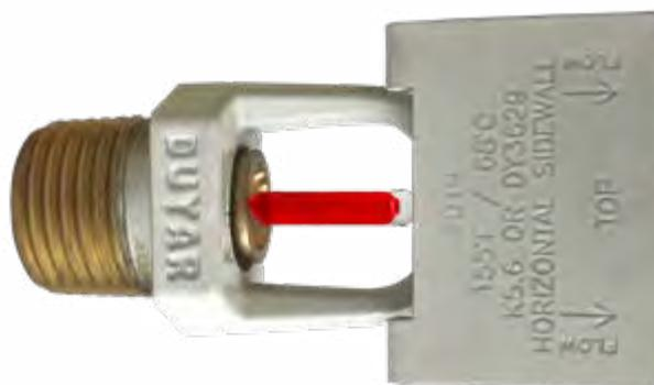
Спринклеры с расширенной зоной охвата предназначены для покрытия большей площади по сравнению со спринклерами стандартного типа. Для размещения в зонах с небольшой опасностью существуют спринклеры, устанавливаемые вертикально розеткой вниз, и настенные спринклеры с расширенной зоной охвата. Термоколбы могут быть стандартными или быстроразъемными.
