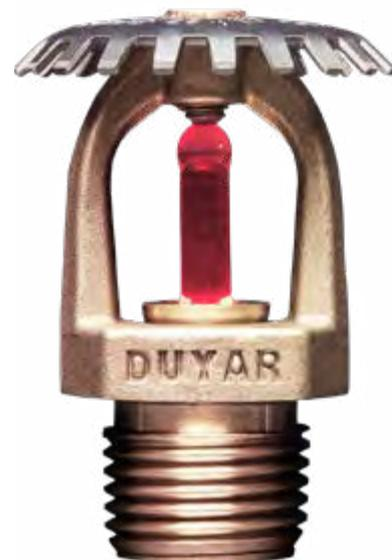
Монтируется в помещениях без подвесных потолков, при этом дефлектор направлен вверх. Вода попадает на дефлектор и разбрызгивается вниз, образуя конус. Может использоваться во влажных и сухих системах, а также в системах превентивного действия.
